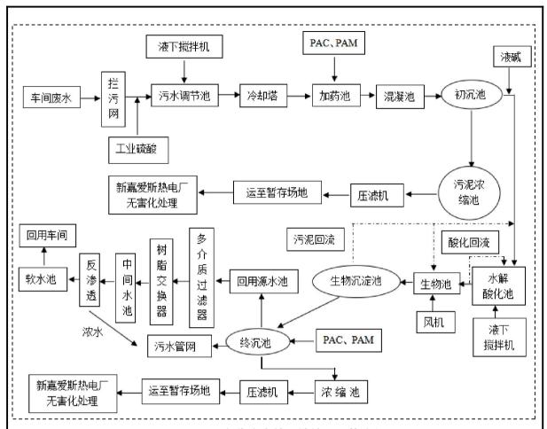
图 2-3 台华废水处理站处理工艺流程图
