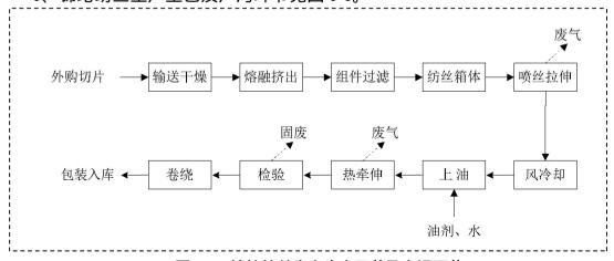
图 1-1 锦纶纺丝生产生产工艺及产污环节
