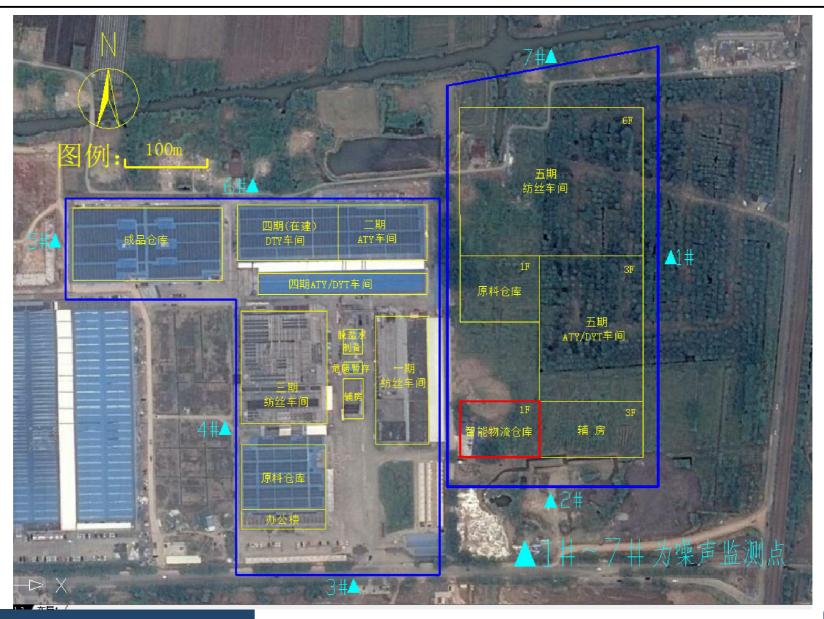
● 附图 5 平面布置及噪声测点图
