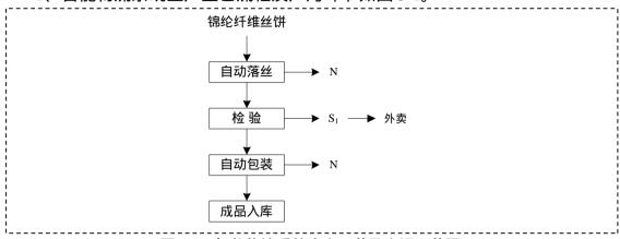
图 5-1 智能物流系统生产工艺及产污环节图
