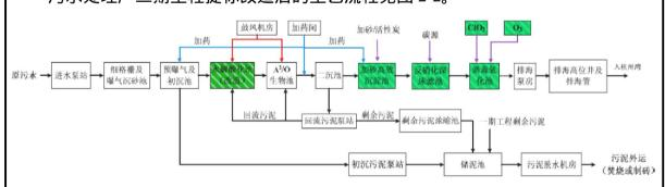
图 2-2 提标后污水处理厂二期工程工艺流程图
