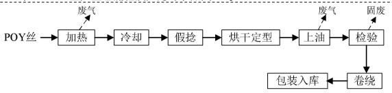
图 1-3 DTY 丝生产工艺及产污环节图
